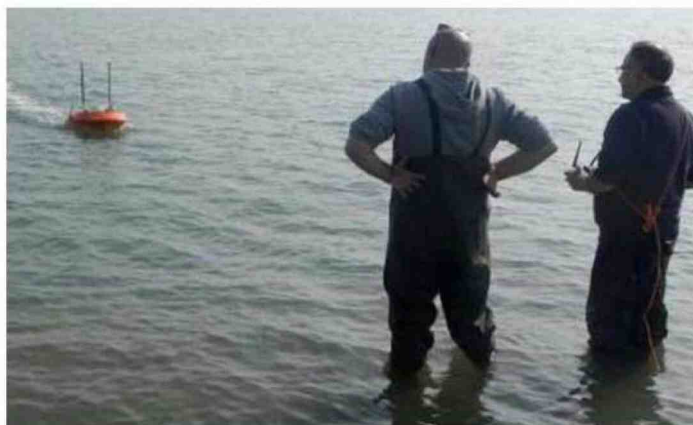
Il drone marino in grado di scandagliare il fondo alla caccia di microplastica
